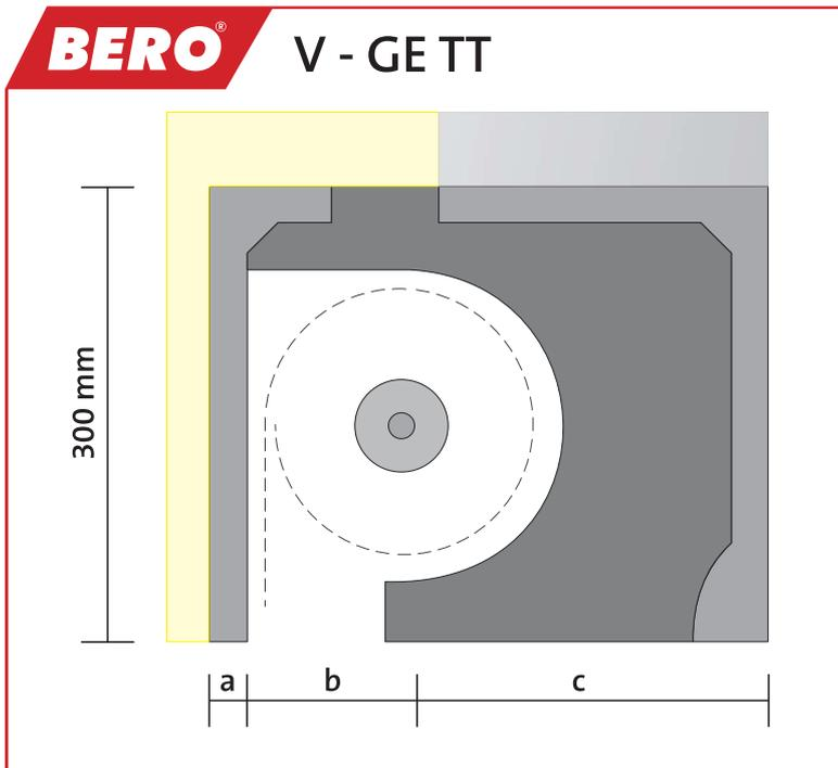
Selbsttragender Rollladenkasten aus bewehrtem BEROPor-Leichtbeton für ein Mauerwerk mit Wärmedämm-Verbundsystem und **äußeren Montageöffnung**. Optimierte Innendämmung und thermische Trennung aus BERO® Porozell (WLS031), gedämmte Kopfteile mit Stehbolzen zur Montage der Lagerhalter.
